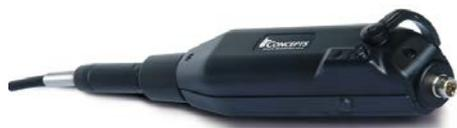
Благодаря новой технологии, яркое освещение исследуемого объекта осуществляется с помощью встроенного светодиода на конце рабочего зонда. Это позволяет полностью исключить потерю света при прохождении через всю длину зонда по волокну и отказаться от использования дорогостоящих ламп. Также удалось уменьшить диаметр зонда до 3 мм (модель IRIS-23СМШ).
